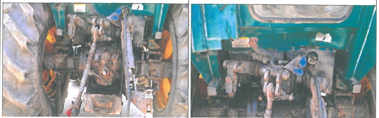
*상,하부 링크 外 파손
