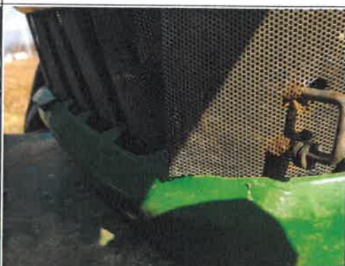
본넷 그릴 파손
