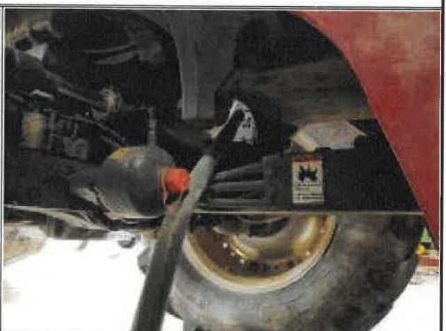
사고당시 상황 재연사진 : 하우스파이프가 유압호스 및 U/J보호커버에 걸려 U/J접촉 불가
