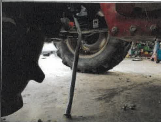
사고당시 상황 재연사진 : 하우스파이프가 유압호스 및 U/J보호커버에 걸려 U/J접촉 불가
