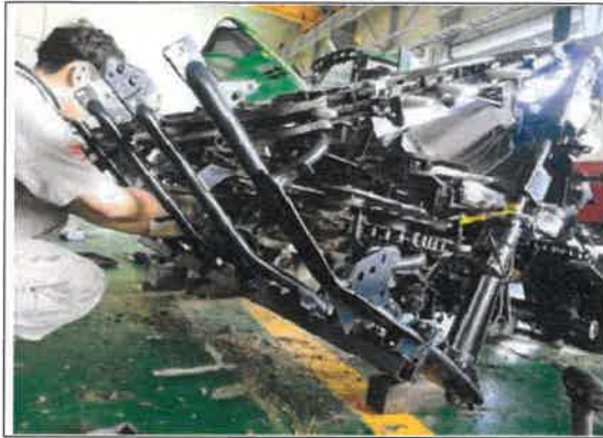
에취프레임 변형교환 작업 사진
