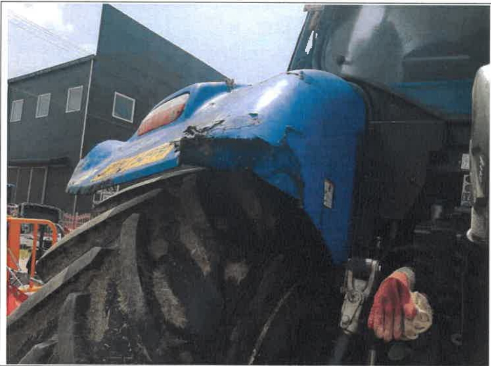
좌측 뒤휨다 파손 사진
