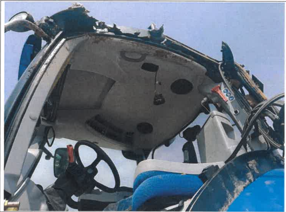
캐빈 실내 파손 사진
