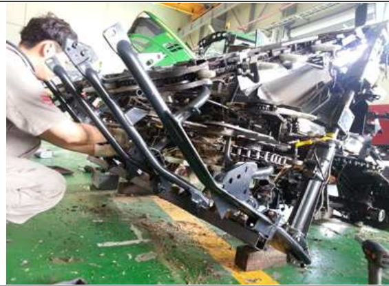
에취프레임 변형교환 작업 사진
