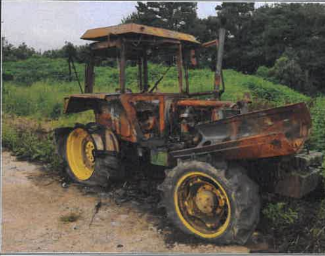
담보물 (외부 충격 사실은 확인되지 않으며, 전기적 합선에 의한 화재로 추정됨)
