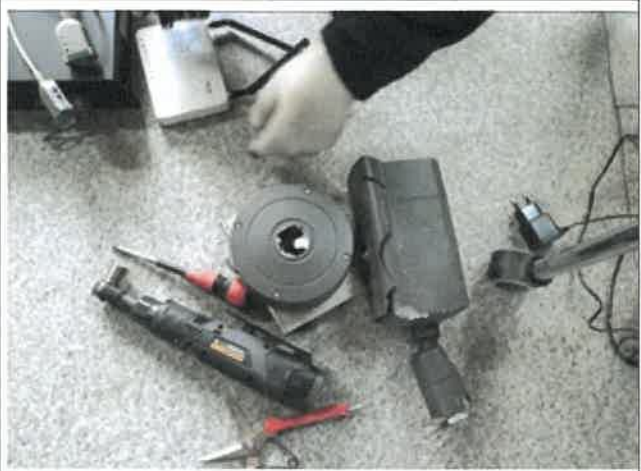
*교통단속용 무인장비 함체& 단속카메라 파손 잔존물 확인 형식 : RB100CP-S2
