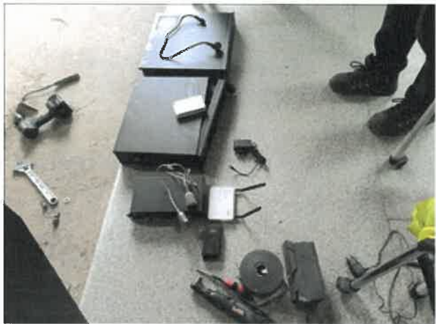
*교통단속용 무인장비 함체& 단속카메라 파손 잔존물 확인 형식 : RB100CP-S2
