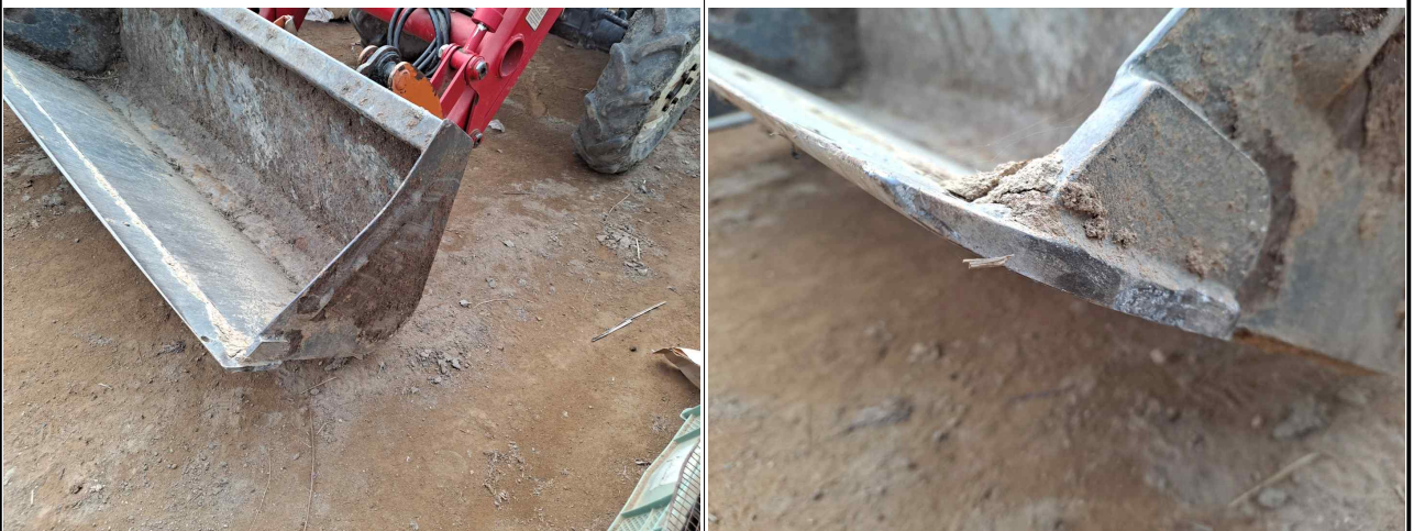
로우더 버킷확인, 피해차량 페인트 흔적 및 충돌흔적 확인
