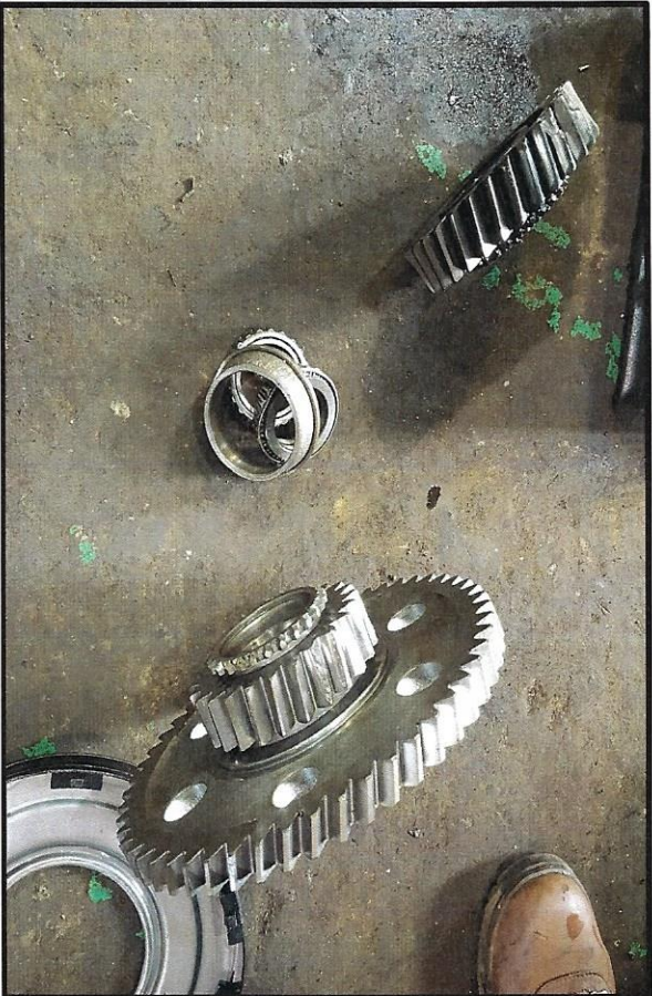
유격이 생겨 내부 기어 베어링 마모 파손 기계적 사고
